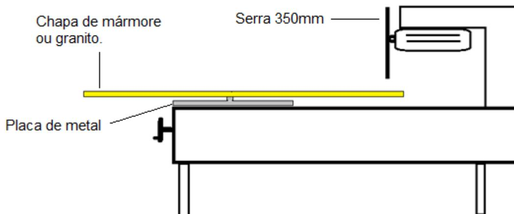
Agora estamos prontos para começar! Peça de ferro fixada e chapa apoiada sobre a mesma, agora é só ligar a serra e ir girando a chapa com a mão, não esqueça que a serra deve descer lentamente à medida que vai cortando a pedra.
