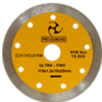
**DISCOS ULTRA-FINOS:** Discos especiais com espessuras que podem variar de 1,2mm até 1,5mm cortam com melhor qualidade evitando que o material fique craquelado nas bordas, com isso evita-se a utilização de outros insumos para correção de tais defeitos. Economia de tempo e insumos.
