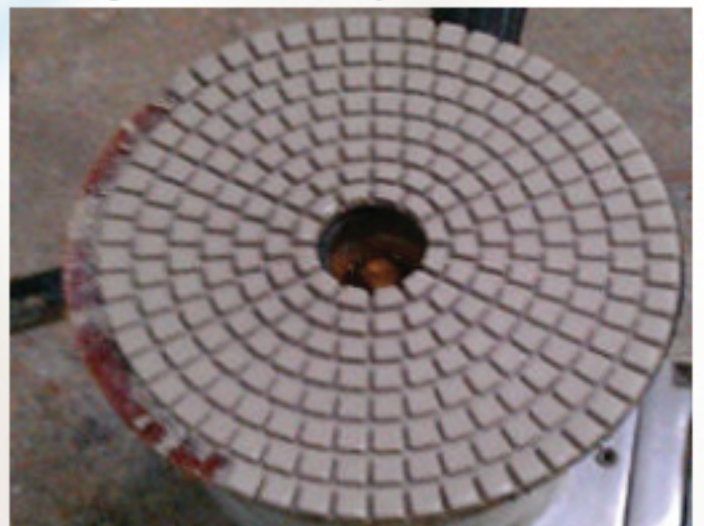
Situação do disco após uso incorreto
